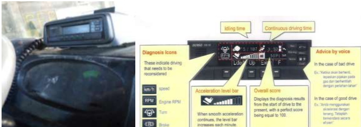
Gambar 1 Tachometer di Dalam Trans Jogja dan Indikator di Dalamnya
