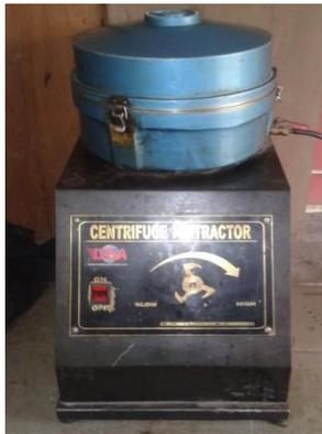
Gambar 1 Alat Uji Ekstraksi Sentrifugal
