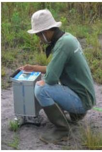
Figure 2.a Gravimeter Scintrex CG-5
