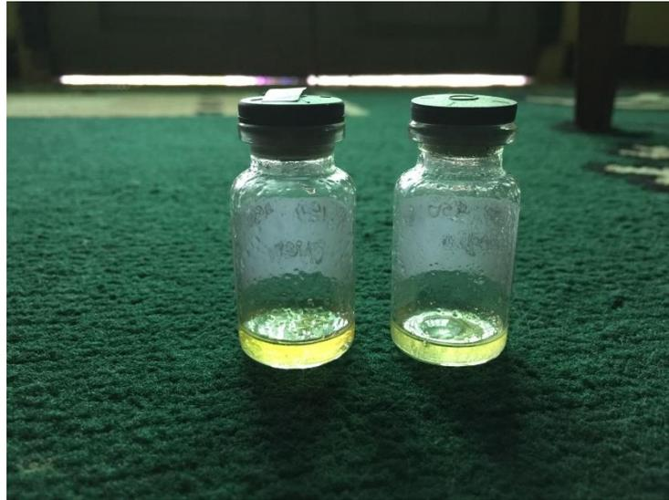
**Gambar 3.** Hasil ekstraksi minyak atsiri serai wangi menggunakan metode *solvent-free microwave extraction*
