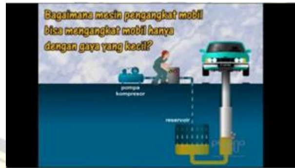
Gambar 1. Media audio-visual tentang penerapan hukum Pascal pada mesin pengangkat mobil (hidrolik)
