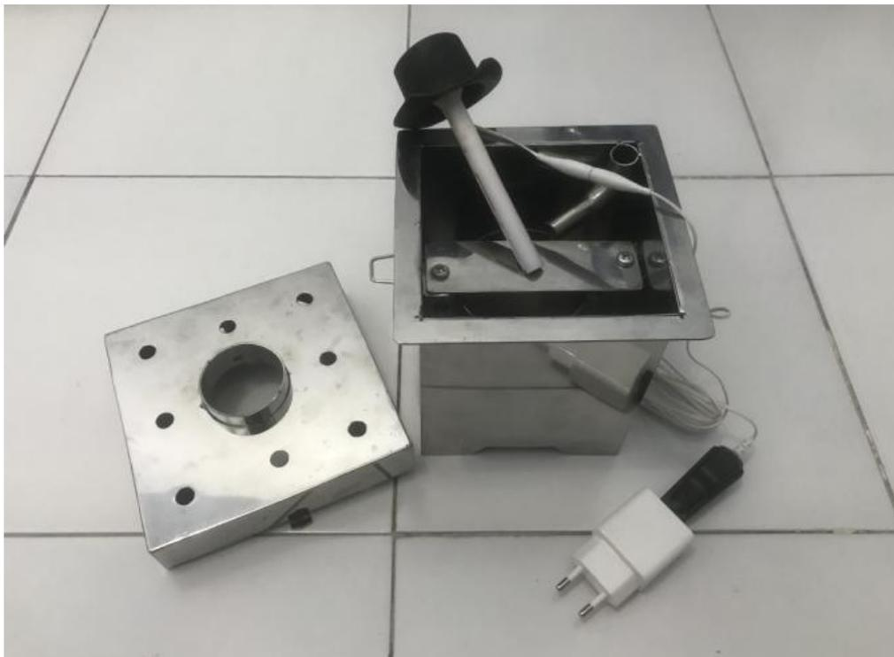
Gambar 6. Prototipe alat *diffuser* pengharum ruangan yang telah dirakit
