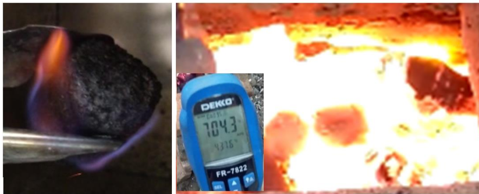
Gambar 2. Uji kualitas nyala api biobriket arang sekam padi
