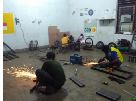
Gambar 4. Proses pemotongan material rangka
