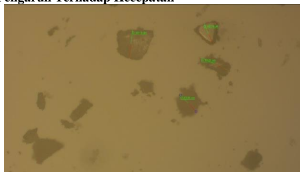
Gambar 2 Penggilingan dengan variasi 150 Rpm dengan penggilingan 2 Jam
