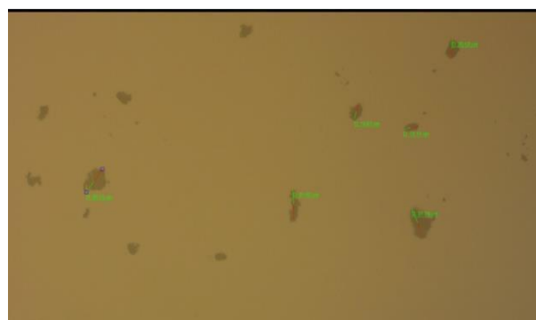
Gambar 3 Penggilingan dengan variasi 200 Rpm dengan penggilingan 2 Jam
