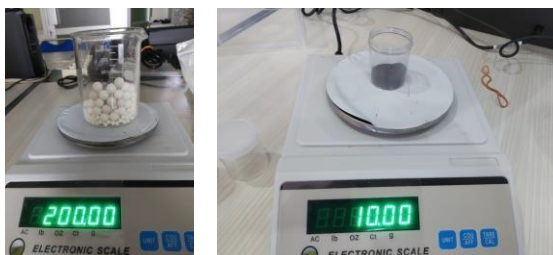
Gambar 1 (a) Bola penggiling 200 gram (b) serbuk SiC 10 Gram
