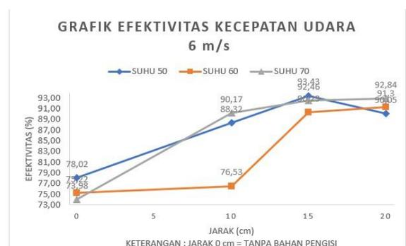
Gambar 2. Grafik efektivitas *cooling tower* kecepatan udara 6 m/s
