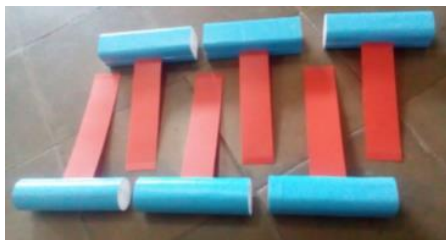
Gambar 8. Bluff body yang terpasang pada kantilever
