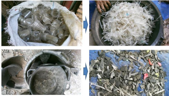
Gambar 3. Chip plastik hasil hancuran mesin penghancur plastik
