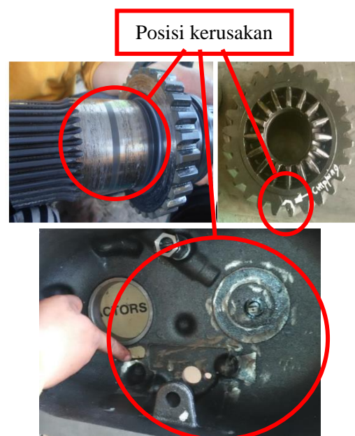
Gambar 2. Kerusakan di beberapa komponen utama differential .
