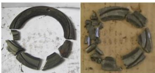
Gambar 1. Bentuk pecahan thrust washer differential
