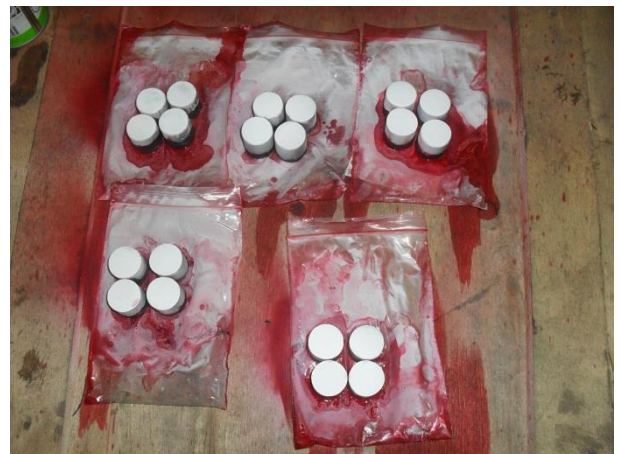
Gambar 13. Proses pengujian DPI dengan developer
