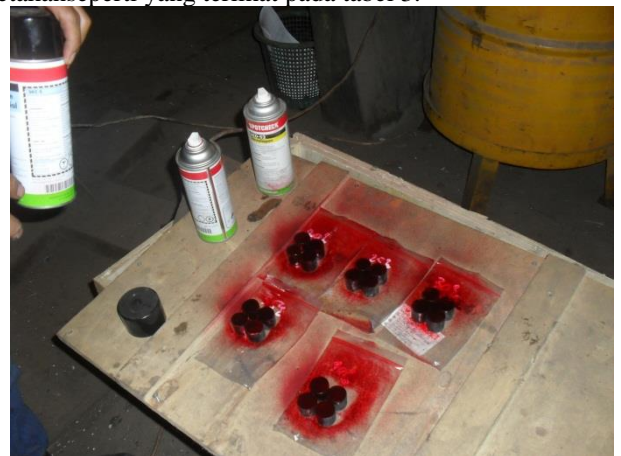
Gambar 12. Proses pengujian DPI dengan penetran
