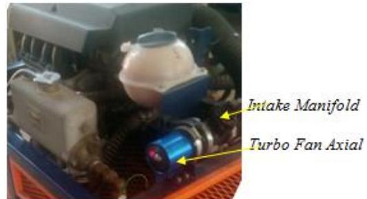
Gambar 4. Pemasangan Turbo Fan Aksial
