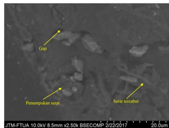
Gambar 3. Pencitraan SEM film biokomposit dengan efek penggetaran 0 menit, perbesaran 2500x
