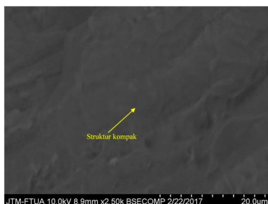
Gambar 6. Pencitraan SEM film biokomposit dengan efek penggetaran 45 menit, perbesaran 2500x
