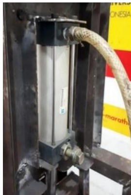
Gambar 2. Mekanisme pemberian beban oleh silinder pneumatic .
