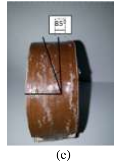
Gambar 3. Foto makro orientasi sudut pada pipa komposit (a)sudut 45^{\circ} , (b) 55^{\circ} , (c) 65^{\circ} , (d) 75^{\circ} , (e) 85^{\circ}
