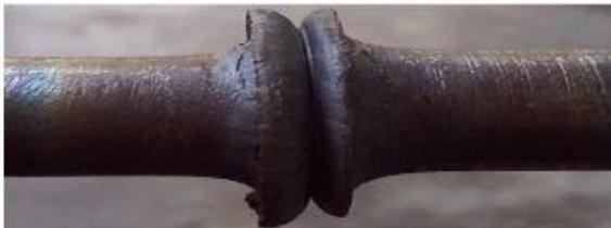
Gambar 2 Tampilan Penampang Horizontal dari Sambungan Las Gesek
