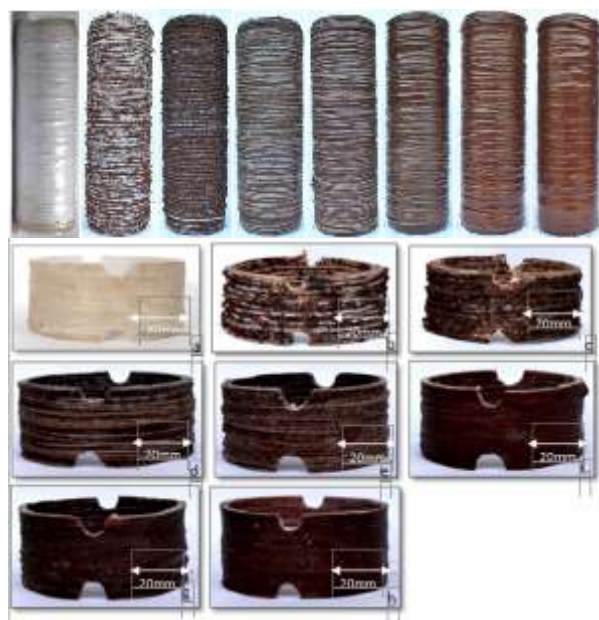
Gambar 1 Foto makro spesimen komposit partikel (MMT) dengan metode filament winding sebelum dan sesudah dipotong.
