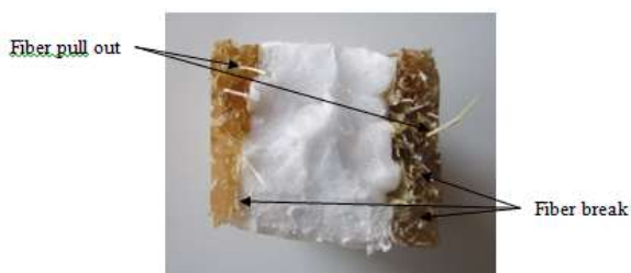
Patahan hasil uji impak fraksi volume 40%
