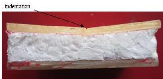
Patahan hasil uji bending fraksi volume 20%
