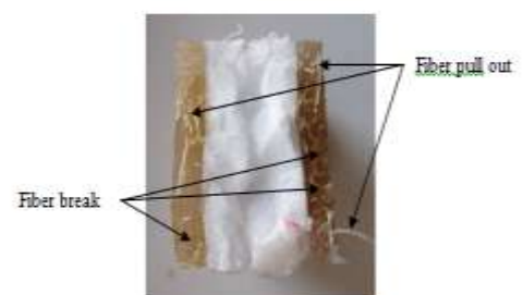
Patahan hasil uji impak fraksi volume 10%
