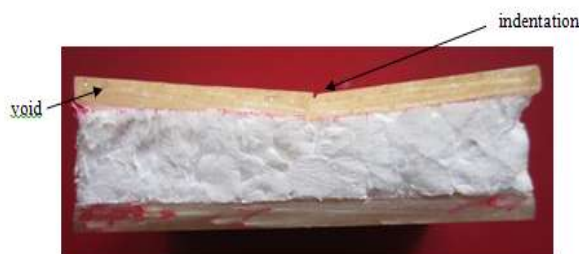
Patahan hasil uji bending fraksi volume 30%
