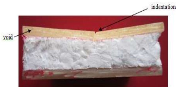
Patahan hasil uji bending fraksi volume 40%
