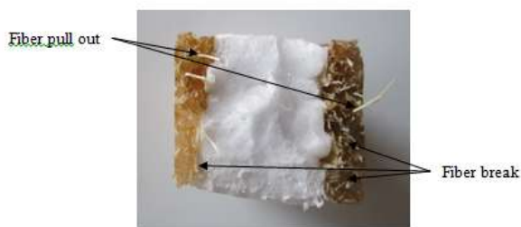
Patahan hasil uji impak fraksi volume 30%
