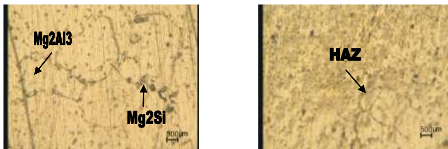
Gambar 10. Weld metal dan HAZ dengan pembesaran 500x, dengan gas 12 liter/menit
