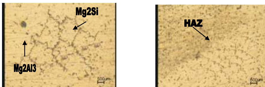
Gambar 11. Weld metal dan HAZ dengan pembesaran 500x, dengan gas 19 liter/menit
