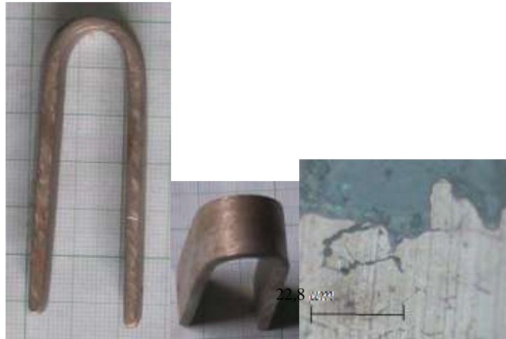
Gambar 6. Hasil korosi material ss 304 pada ph 1 dan suhu 50 0 c selama 171 jam. sudah timbul produk korosi pada permukaannya.
