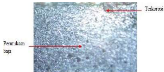
Gambar 11. Struktur mikro variasi konsentrasi 1500 ppm selama 40 hari dengan pembesaran 200x
