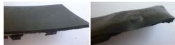
Gambar 8. Bentuk fisik karet belt setelah dilakukan proses pemanasan, (a) suhu pemanasan 130^{\circ}\text{C} dan 150^{\circ}\text{C} , (b) suhu pemanasan 170^{\circ}\text{C}
