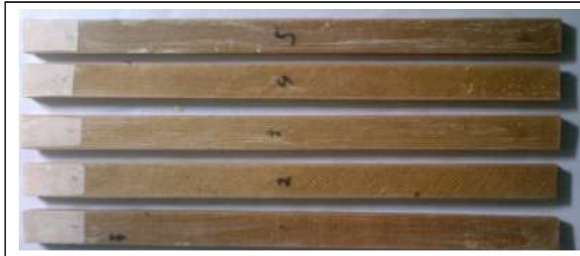
Gambar 3. Foto batang komposit rami dengan lima variasi orientasi arah serat
