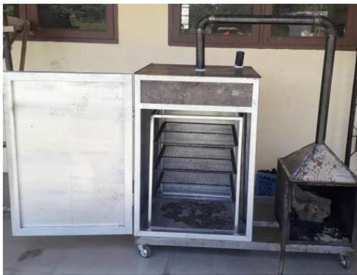
Gambar 2. Alat pengasapan ikan dengan sirkulasi asap tersebar merata
