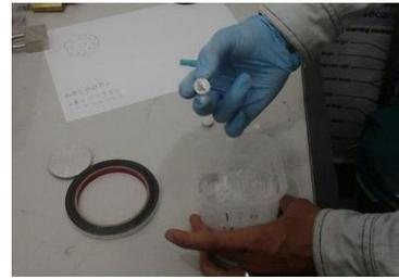
Gambar 3. Proses pengambilan sampel untuk pengujian serbuk menggunakan SEM.
