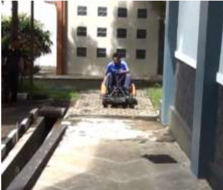
Gambar 8. Pengujian POLTEKOM Electric Car di Jalan menanjak (10°).
