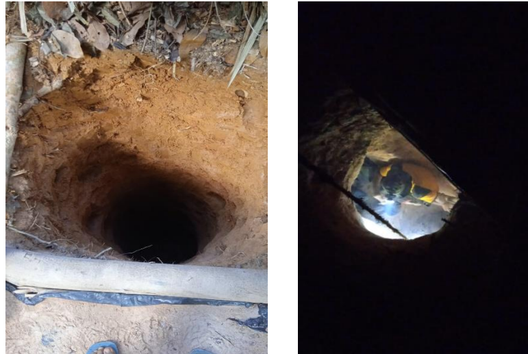
Gambar 2. Penggalian lubang di bawah tanah untuk mencapai endapan timah Sumber: foto pribadi
