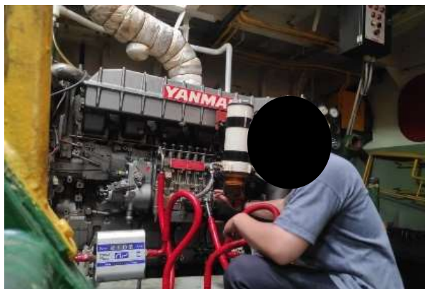
Gambar 7. Modifikasi penambahan filter bahan bakar di kapal Tug Boat
