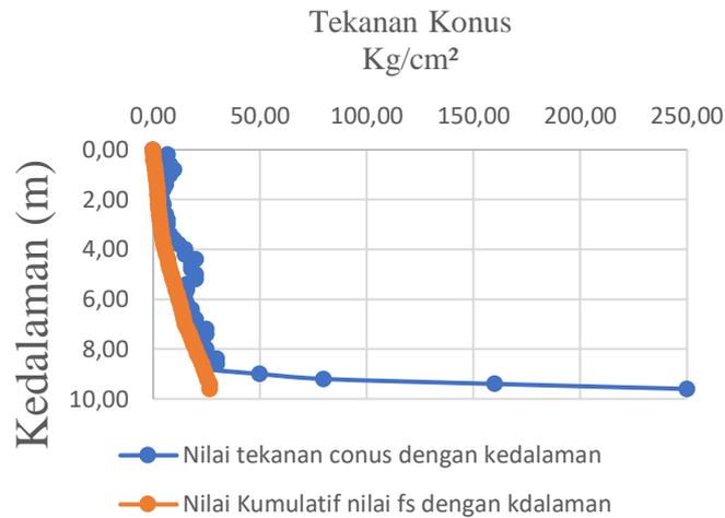
Gambar 1. Grafik hubungan sondir dengan kedalaman
