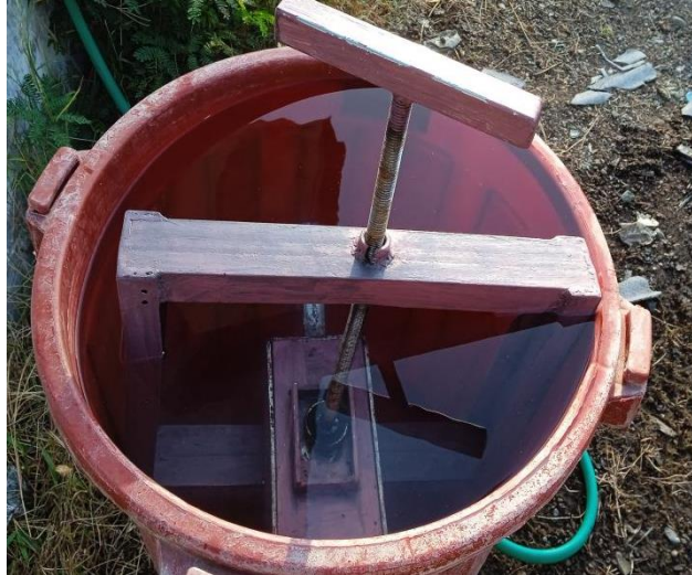
Gambar 4. Posisi perendaman cetakan paving berisi adonan paving
