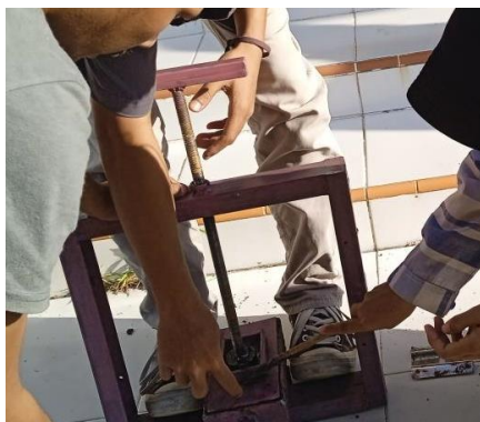
Gambar 3. Posisi cetakan paving setelah semua adonan dituang
