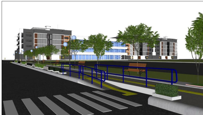
Gambar 2. Rekomendasi Ramp dan Handrailing Untuk Difabel
