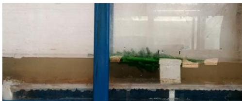
**Gambar 6** Tampak samping penumpukan aliran debris pada flume
