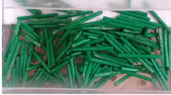
**Gambar 7** Tampak atas penumpukan aliran debris pada flume
