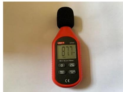
**Gambar 3** Desibel Meter, alat yang digunakan untuk mengukur tingkat kebisingan dalam suatu ruangan
