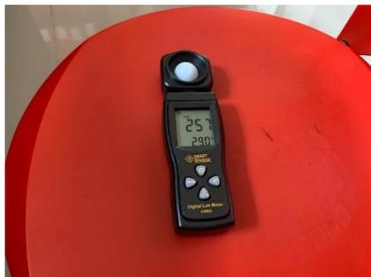
**Gambar 2** *Lux* Meter, alat yang digunakan untuk mengukur tingkat pencahayaan dalam suatu ruangan
