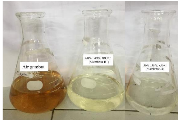
Gambar 3. Perbandingan air gambut sebelum dan setelah proses filtrasi
