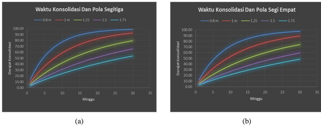
**Gambar 2.** Grafik hubungan antara  $\bar{U}$  dengan waktu derajat konsolidasi pada pemasangan pola (a) Segitiga dan (b) Segiempat
