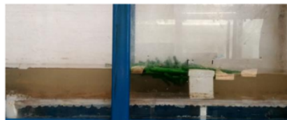
Gambar 6 Tampak samping penumpukan aliran debris pada flume
