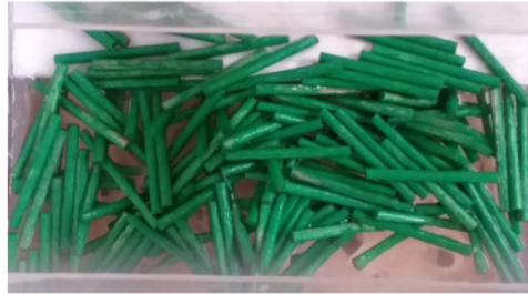
Gambar 7 Tampak atas penumpukan aliran debris pada flume
