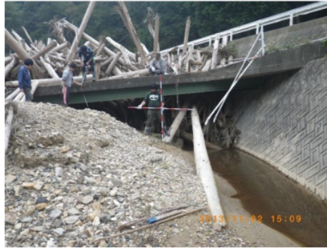
Gambar 2 Penumpukan aliran debris kayu pada jembatan yang berada di Sungai Nayoshi (Tsuwano, 2013)
