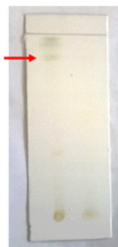
Gambar 1. Hasil positif uji flavonoid ditunjukkan dengan noda kuning kehijauan yang ditunjukkan oleh tanda panah
