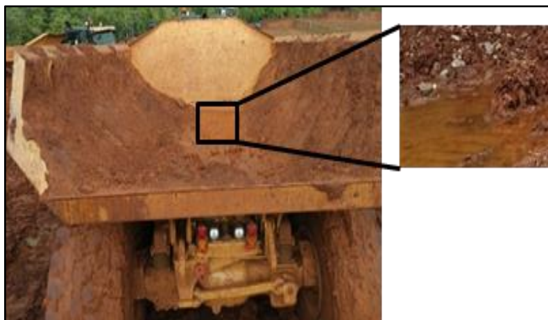
Gambar 4. Bak truk yang mengandung air
