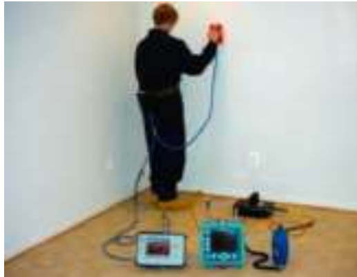
Gambar 7 Aplikasi GPR untuk menyelidiki struktur beton pada dinding (www.lipi.go.id)
