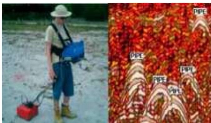
Gambar 6 Aplikasi GPR untuk mendeteksi keberadaan pipa ( www.testindo.co.id )
