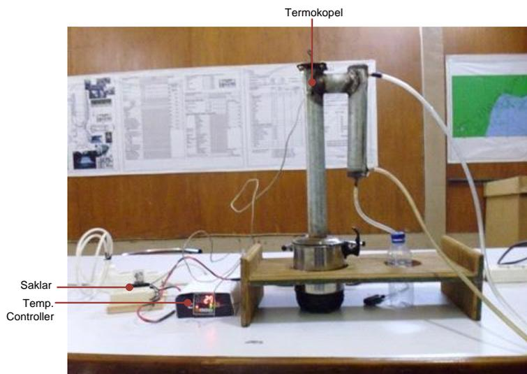
Gambar 4. Prototipe destilator skala laboratorium
