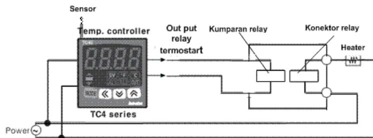
Gambar 3. Rangkaian kontrol suhu otomatis
