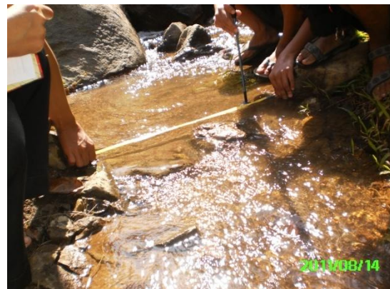
(b) Mengukur kecepatan aliran (titik 2)
