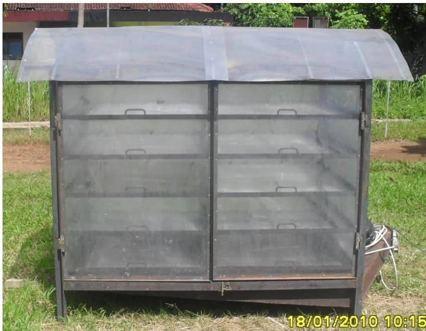
Gambar 1. Alat pengering hibrid tipe rak (Warji, 2009)
