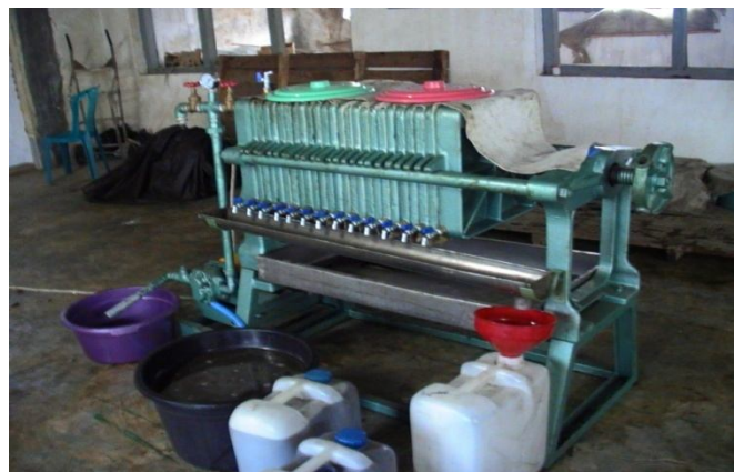
Gambar 5. Filter press sebagai penyaring produk biofuel
