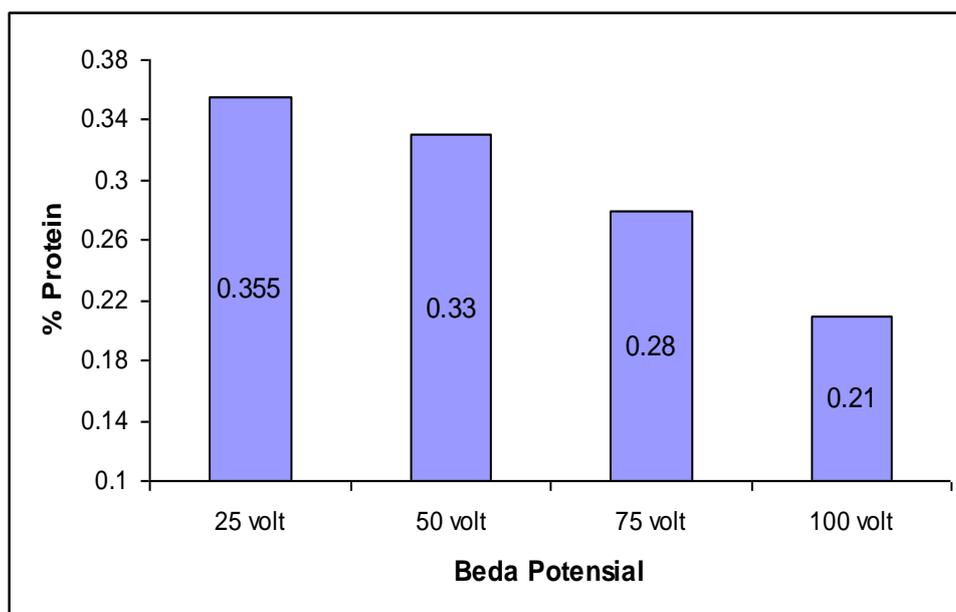
**Gambar 4.** Perubahan kadar protein nira pada berbagai beda potensial elektroforesis pada pH nira awal 7
