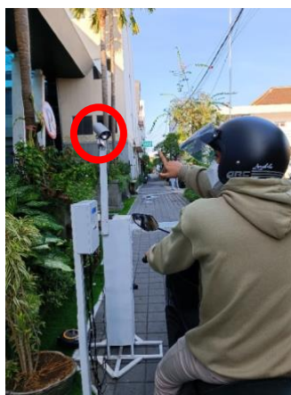
Gambar 8. Indikasi Modul ESP32 Camera Mengambil Gambar
