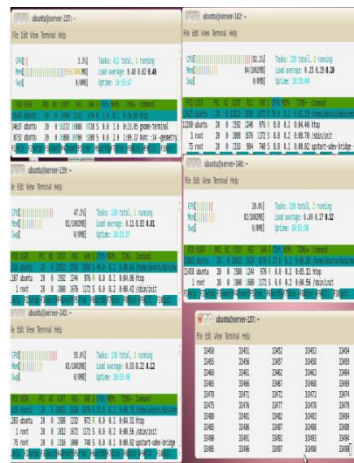
Gambar 7 Monitoring sistem cluster menggunakan HTOP
