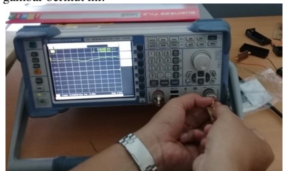
Gbr 9. Konfigurasi antenna dihubungkan pada network analyzer
